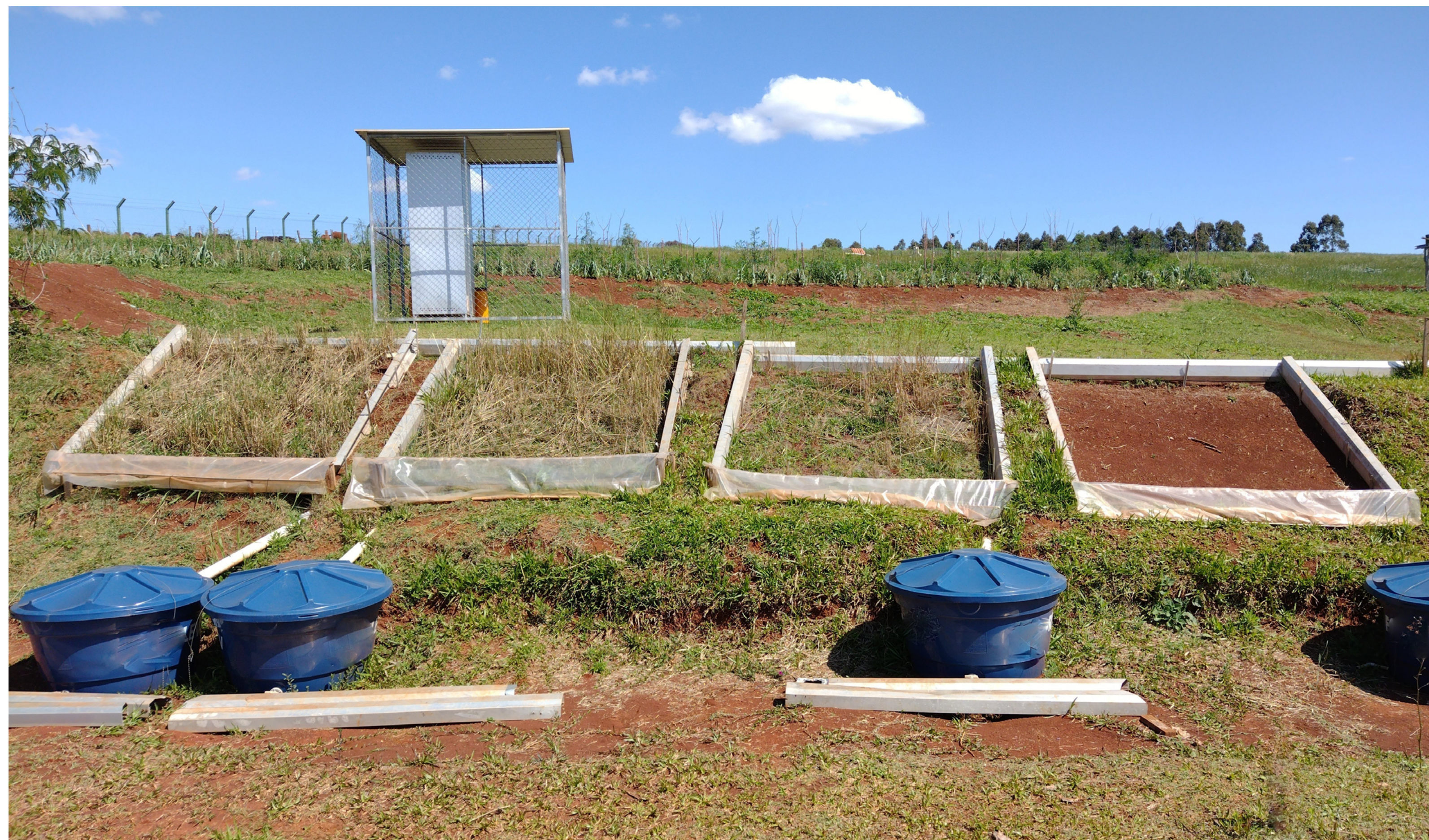
Avaliação do controle de erosão de taludes com diferentes materiais geossintéticos
